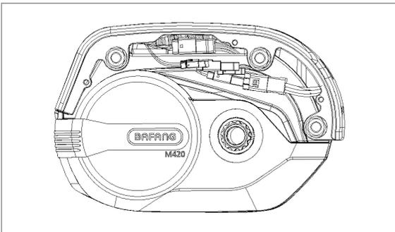
Verlegen Sie die Kabelanschlüsse ordentlich und ohne dass diese eingeklemmt zu werden, damit der Motor einfach gesichert werden kann. Siehe nachfolgende Abbildung.
